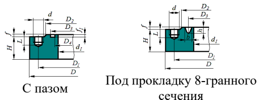
Рис. 3.212 Варианты исполнения фланцевой бобышки
